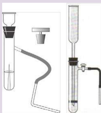
Рис. 7. Прибор для получения и собирания газов
