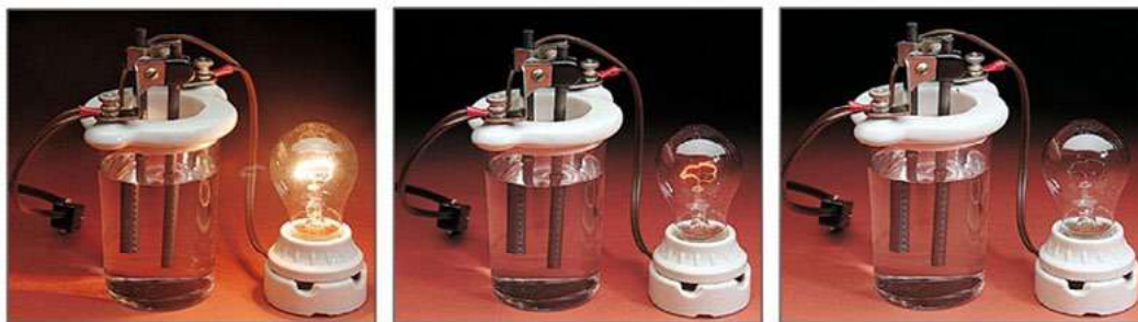
Рис. 23. Приборы для измерения электропроводности веществ
